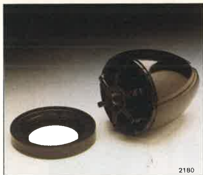
45.1 デュオプロップ、タイプAプロペラ (DP280、290 ディーゼルエンジン用、 KAD42、43、44 除く)
